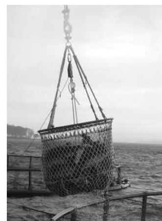
Epuisette grande capacité filet intérieur 11 mm et filet extérieur 50 mm
