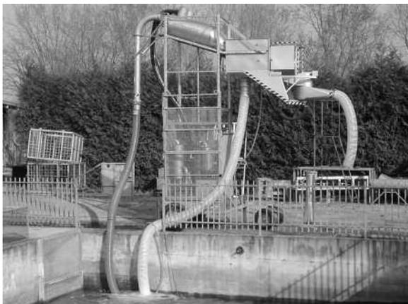
**Modèle vacuum 185 VACREGBA/BS avec pesage et surélévation pour chargement de camion**
